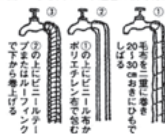
〈図1〉むき出しの水道管の防寒方法
