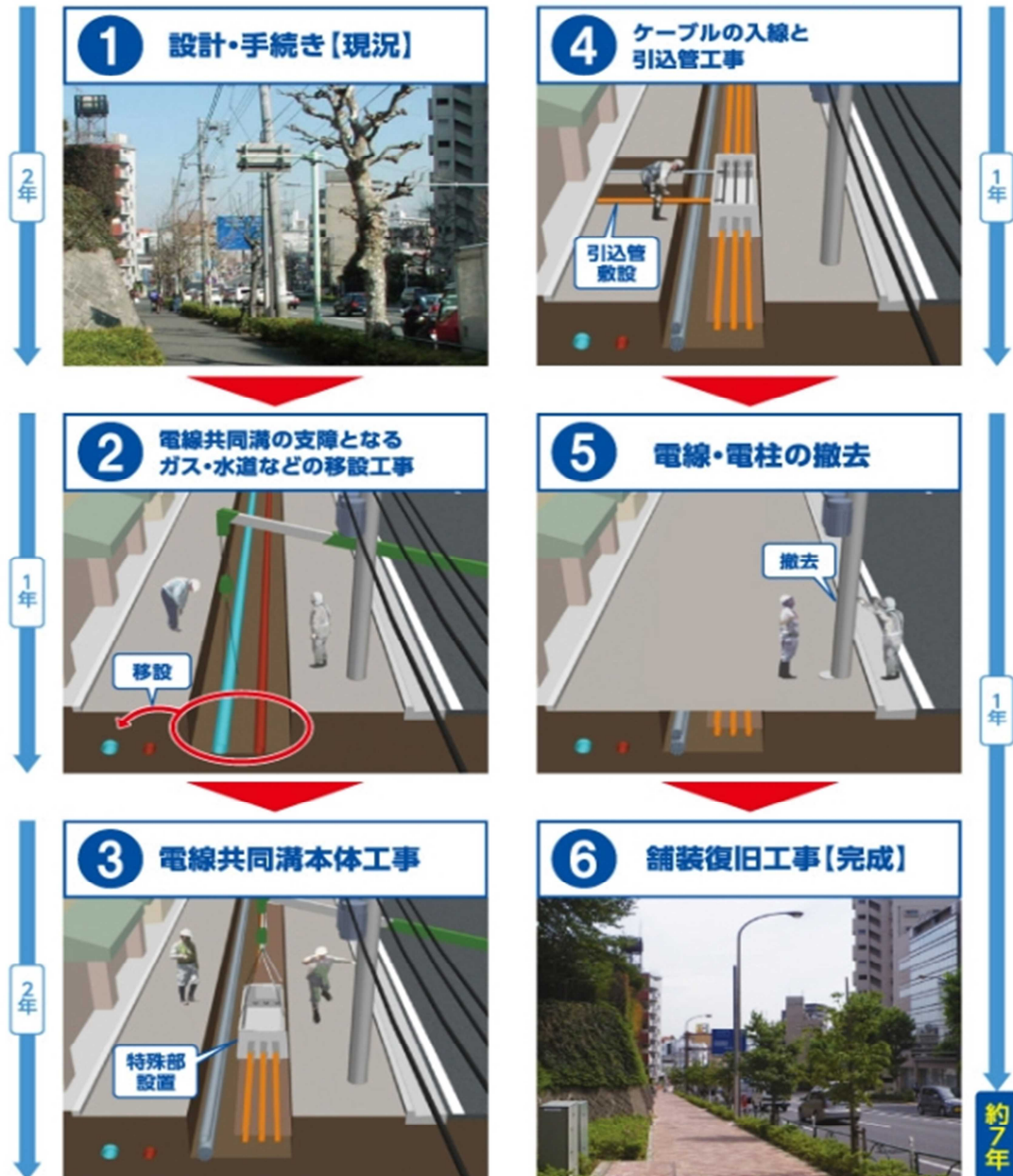
図 3-4 電線共同溝の整備の流れ
